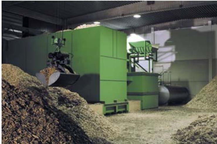
Abbildung 3-5 Holzvergasungsanlage (Quelle: Mothermik GmbH)
