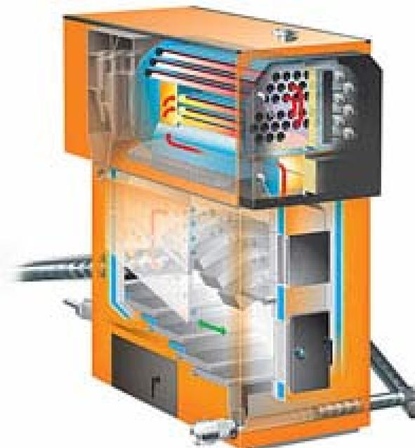
Abbildung 3-3 Biomassekessel mit Vorschubrostfeuerung
