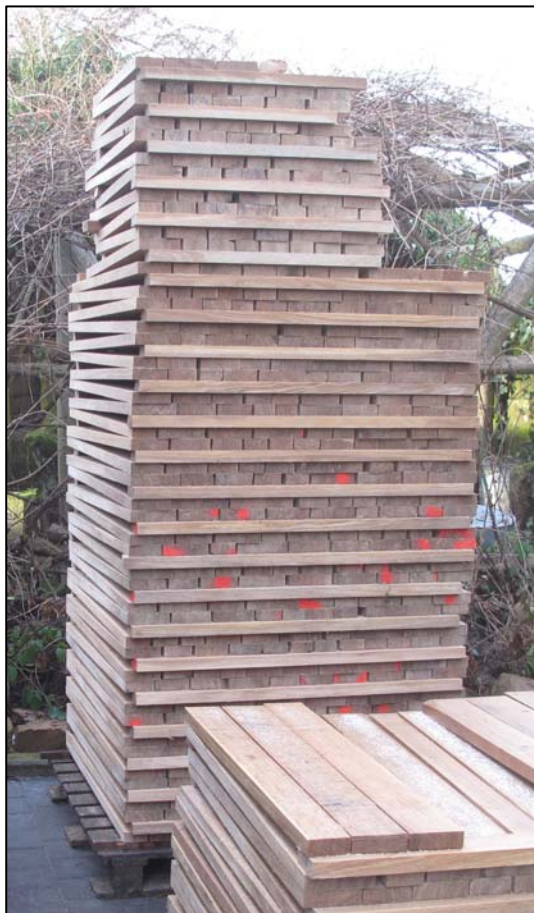
Abb. 7 (links): Schwellenstapel zur Reifung der Rohdauben
