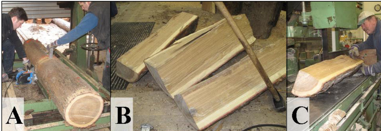
Abb. 6 (oben): Einteilung der Fassholzstämmen in Rollen (A), Spaltung der Rollen (B) und Einschnitt der Spaltlinge zu Rohdauben (C)
