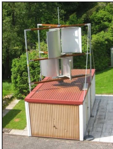
Abb. 21: Eigenbau eines Savonius-Rotors auf einem Garagendach (Quelle: Herr-Home, 2010)
