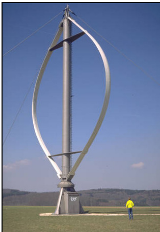
Abb. 10: Darrieus-Rotor (Quelle: BWEA, 2010b)
